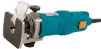
FRESADORA PERFILADORA FR192VG P.8 VIRUTEX 1.000 W, Ø fresa máx.: 25 mm, Ø pinza estándar: 8 mm. Velocidad en vacío: 14.000 - 30.000 /min. 1,8 kg. Perfilado de estratificados de todo tipo, pequeñas molduras, encajes de pernios y bisagras (con portaplantillas Virutex), repaso de galces en puertas o ventanas (usando para ello la fresa especificada). Sin más accesorios que los incluidos puede hacer regatas rectas o circulares.
