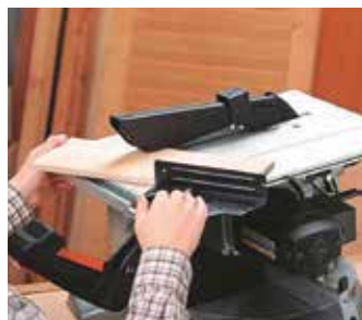
Potencia: 1.500 W. Velocidad en vacío: 3.700/minuto. Tronzadora abatible portátil de gran precisión y potencia. Dotada con disco profesional de 300 mm de diámetro en metal duro y de 48 dientes. Corte hasta 160 x 95 mm o 200 x 45 mm con el plato y cabezal a 0°. Peso 20 kg.
